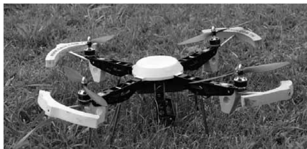
Fig. 4. Il quadricottero GAUI utilizzato per la battuta fotografica dei due siti archeologici campione.
