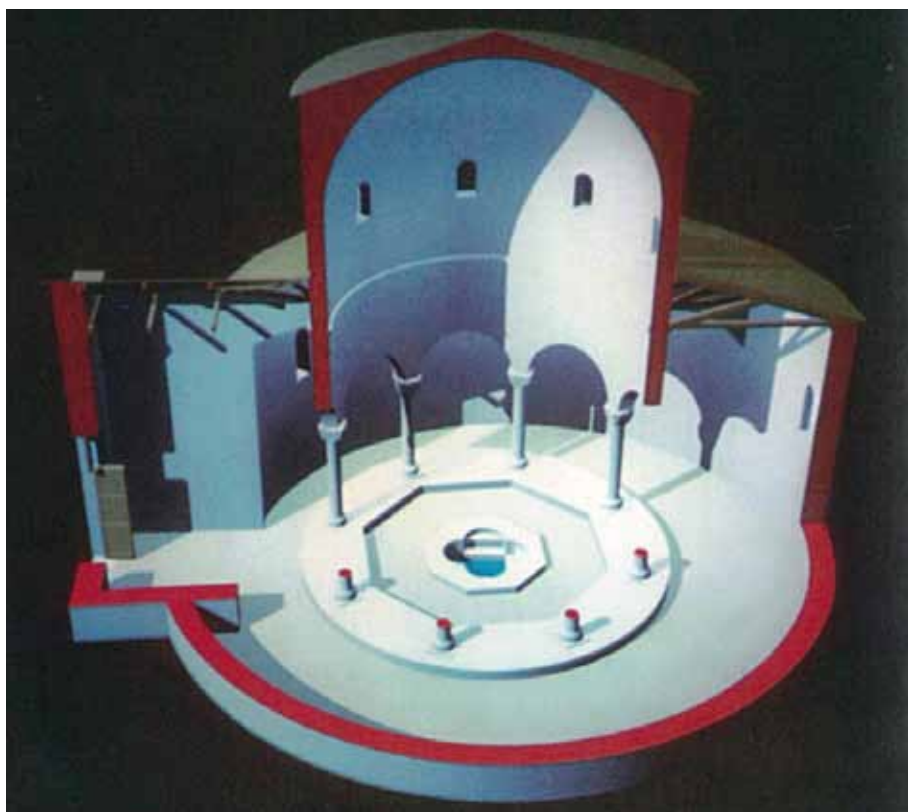
Fig. 3. Lucera, complesso paleocristiano di San Giusto: ipotesi di ricostruzione del battistero (da VOLPE, BIFFINO, GIULIANI 2001).
